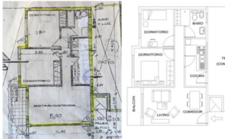
FIGURA 10: (a) Croquis originales de una dada propiedad; (b) croquis dibujados con el programa Autocad.
